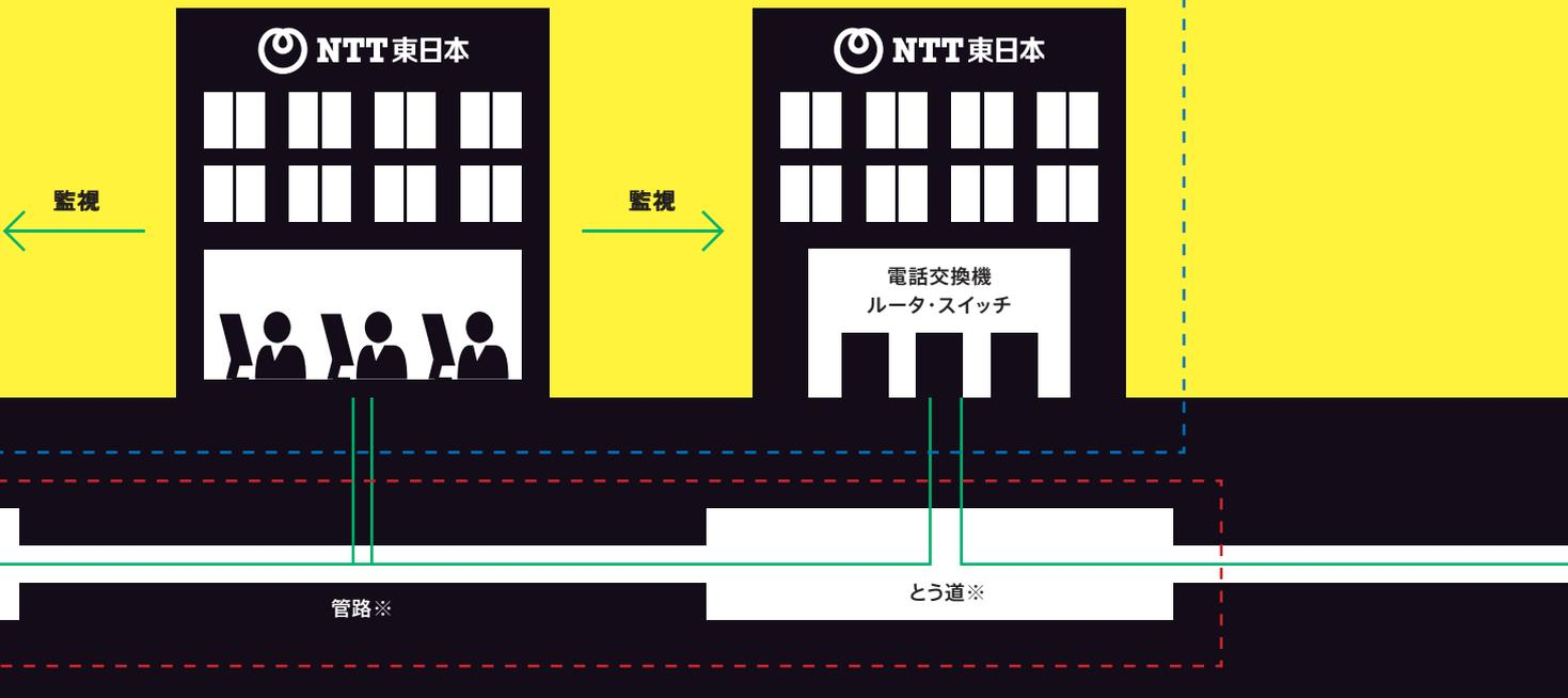
※管路…マンホールとマンホール間等の地下ケーブルを収容するための管。 ※とう道…NTTビルの地下にあり、通信ケーブルを収容するためのトンネル。
